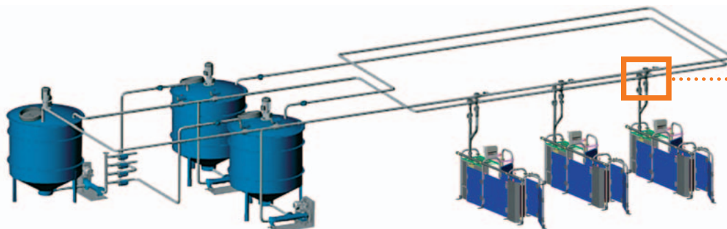
Schemat funkcjonowania sterowanego komputerowo systemu karmienia na mokro przy zastosowaniu dwóch rodzajów paszy (dwa zbiorniki zapasowe i dwa obiegi)
